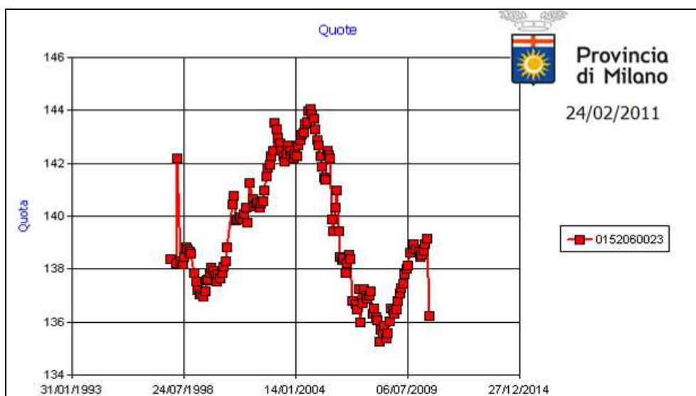
Figura 38 – Andamento temporale del livello di falda nei pressi dell'invaso di Senago.
